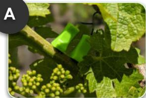
Brancher les **électrodes bord à bord** sur les rameaux primaires de la vigne au niveau du 2ème mérithalle dans le flux de sève.
