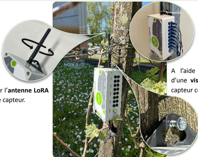
A l'aide de **serflex** ou d'une **vis à bois**, fixer le capteur contre le piquet.
