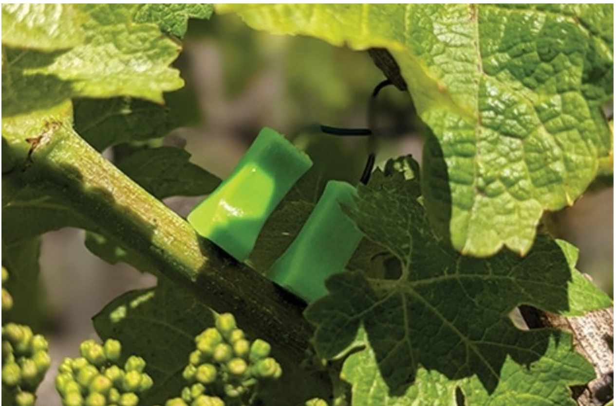
Les capteurs sont alimentés par des panneaux solaires et composés de 8 paires d'électrodes permettant de suivre l'activité de 4 pieds de vigne. - crédit photo : Vegetal Signals
